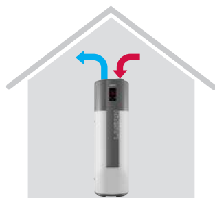
Entrada y salida de aire directa del local donde está instalado
