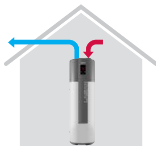
Entrada directa del local donde está instalado y salida canalizada al exterior
